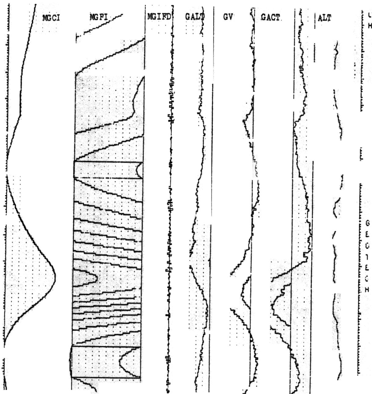
GSM-11GH TRIDIRECTIONAL GRADIOMETER TEST SURVEY
